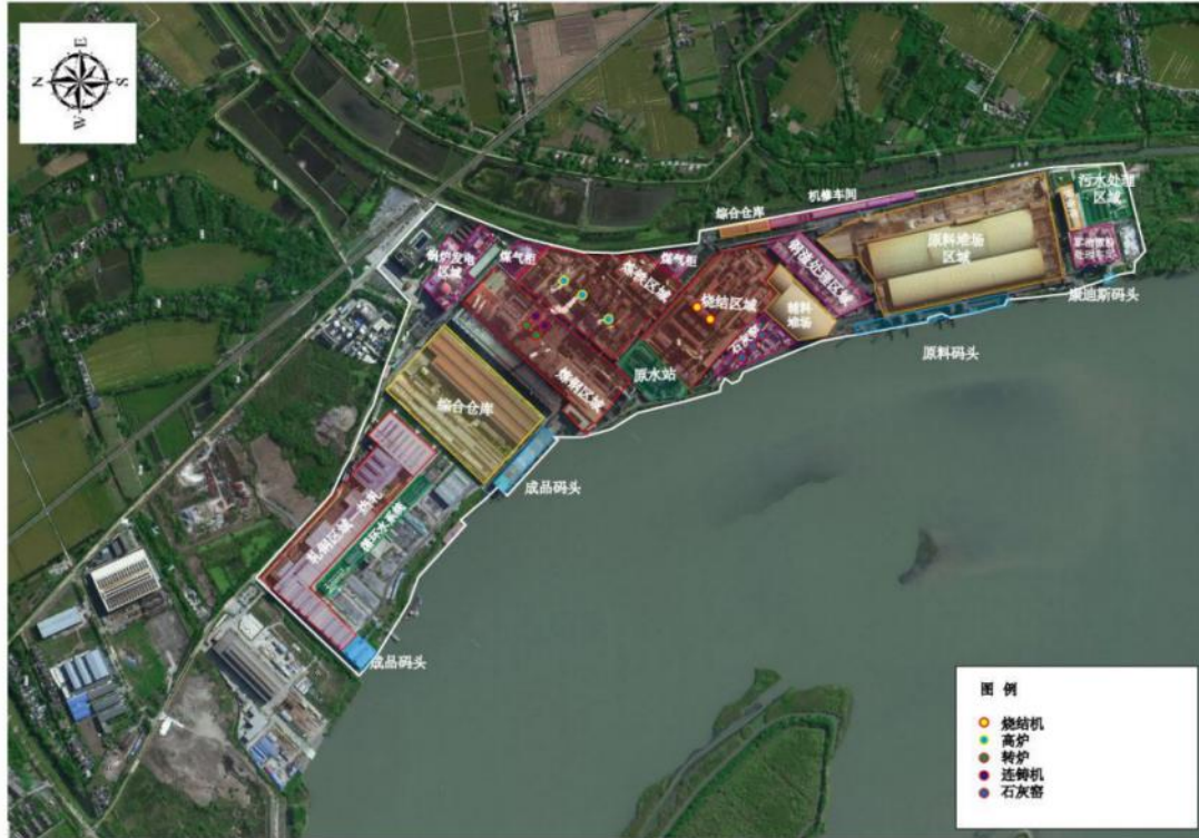
图 1.1-1 恒润重工生产厂区总平面布置图
